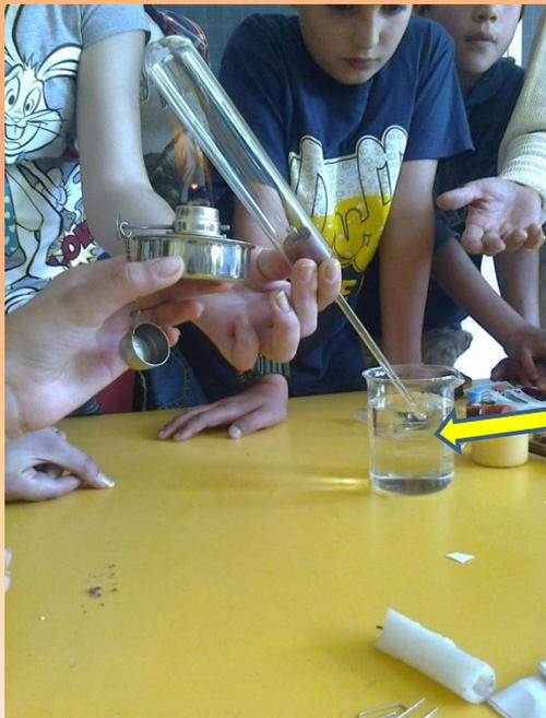
Riscaldando però la provetta, ovvero l'aria in essa contenuta, ecco comparire delle bolle nell'acqua: l'aria si è dilatata ed è finita in parte nell'acqua.
