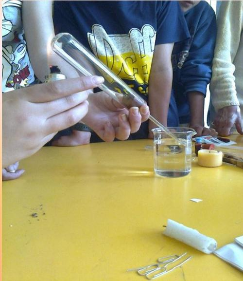
I ragazzi usano una provetta chiusa da un tappo di gomma forato, nel cui foro è inserito un tubicino di vetro vuoto e aperto alle due estremità, precisando che la provetta sembra vuota ma che in effetti è piena d'aria. Immergono l'estremità libera del tubicino nell'acqua contenuta in un becher per dimostrare che non si verifica alcun fenomeno.
